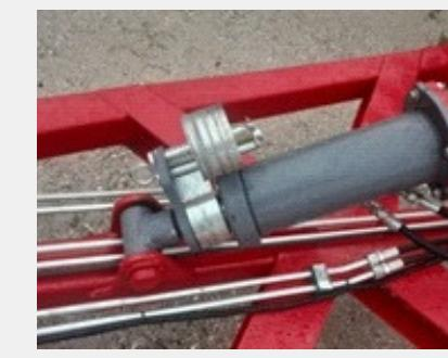
Regulación de inclinación de chasis con respecto a la lanza mediante un cilindro hidráulico con un sistema de topes a resortes, para asegurar la posición del cilindro y la inclinación deseada en todo momento del trabajo.
