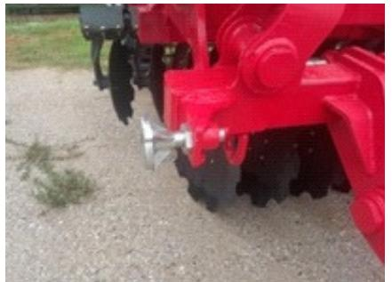
Sistema de nivelación de alas a rosca, para asegurar un correcto nivelado de las alas con respecto al chasis central.
