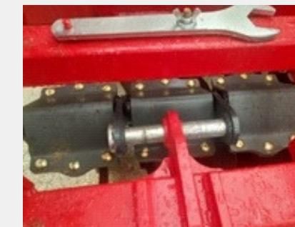
Regulación de paquete delantero para distintos trabajos y cruce de paquete delantero con respecto al trasero, con sistema de topes que asegura la posición en el trabajo y además evita que los discos delanteros se muevan en posición de transporte.
