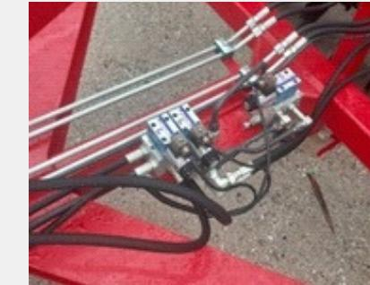
Electroválvula que divide los comandos entre regulación de altura de lanza e inclinación de la rastra hacia adelante y coloca el sistema de alas en flotación para asegurar el copiado de terreno y la correcta nivelación del mismo.
